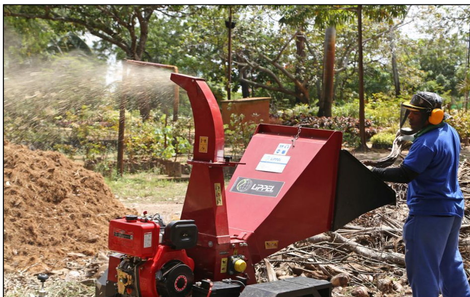
Figura 106 – Exemplo de triturador de galho.
