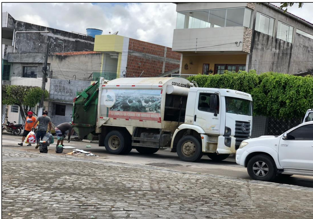
Figura 36 – Caminhão compactador utilizado pela Prefeitura Municipal.
